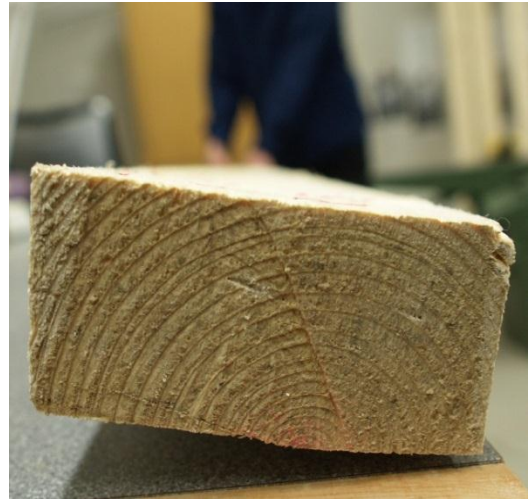
Kuva 3. Sahatavaran muodonmuutokset kuivauksessa: Järjestyksessä ylhäältä alas lapeväääryys, syrjäväääryys, kierous (Kuva: Pohjoismainen sahatavara – lajitteluohjeet 1994). Oikealla kiero sahatavarakappale tämän tutkimuksen aineistossa.
