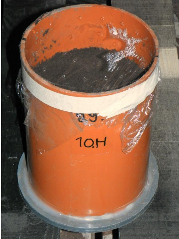
Kuva 8. Käyttäytymiskokeen koeastia. Astiasta on poistettu maa-aineksia erottava välilevy, ja se on valmiina siirrettäväksi kasvatushuoneeseen. Yhdessä astiassa oli kahdeksan lieroja ja astioita oli yhteensä 16, kahdeksan molemmissa (kahden ja 14 päivän) kokeissa.
