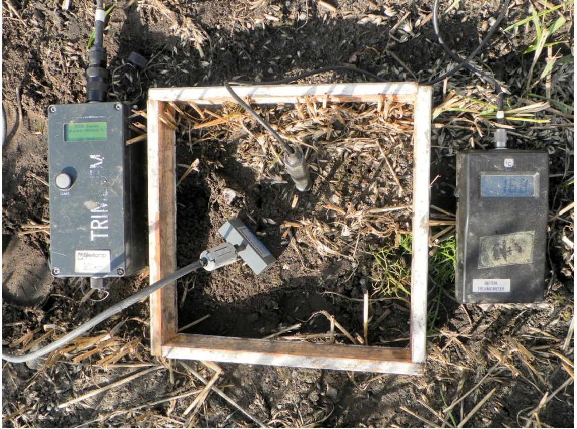
Kuva 10. Kenttäkokeen näytekehikko ja TDR sekä lämpötilamittaus.
