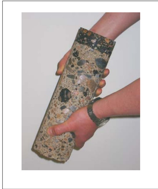
Kuva 6-3: Esimerkki tuotekehityksen tuloksesta. Kuvan näyte on porattu KT87, lisalmi-Nurmes parannushankkeesta, jossa vanha asfaltti on jyrinstabiloitu yhdessä kipsi-tuhka-seoksen kanssa vanhaan tierakenteeseen. Stabiloinnin päällä on uusi asfalttipinta (Kuva: Ramboll Finland Oy).
