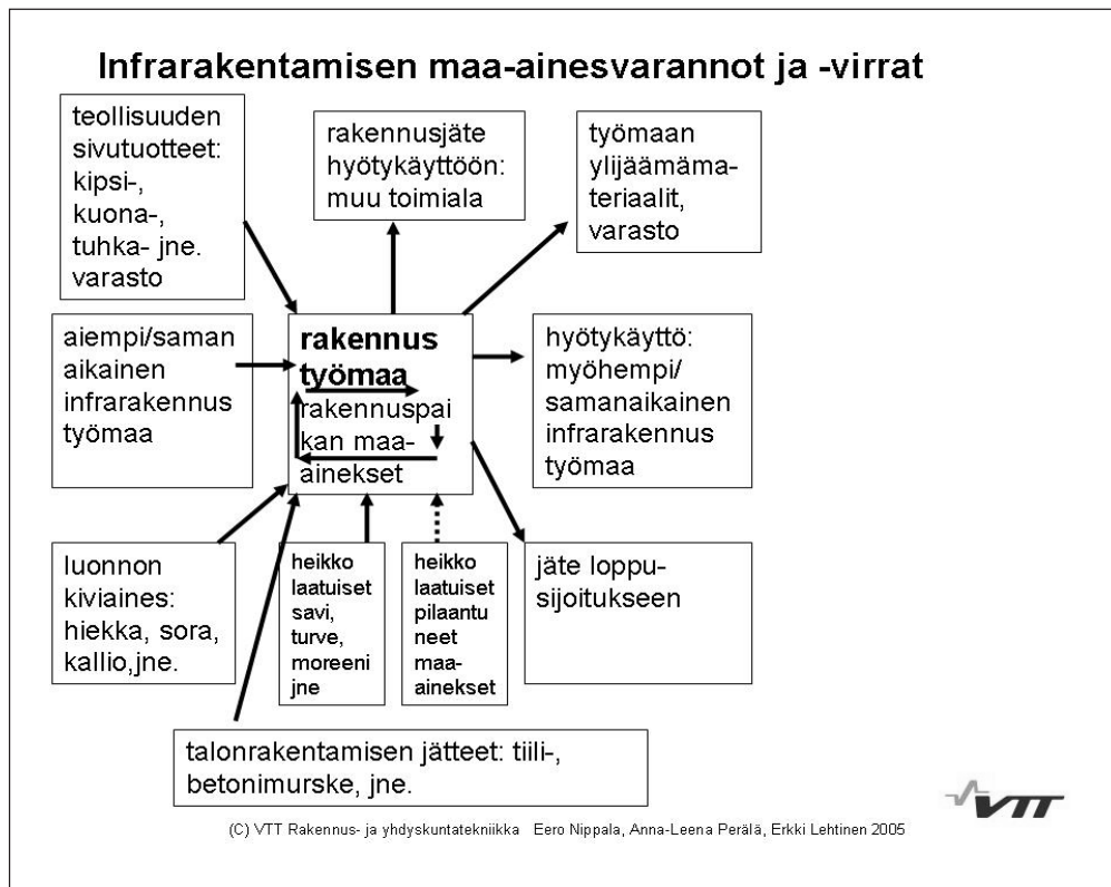
Kuva 2-1. Infrarakentamisen maa-ainesvarannot ja -virrat.
