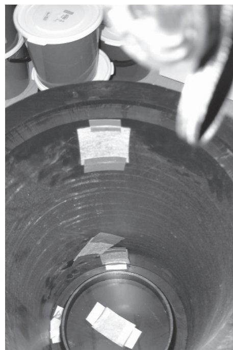
Kuva 19. Mittaussellin pohja. Venttiilien reiät peitetty suodatinkankaalla.
