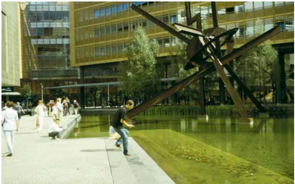
Kuva 11. Potsdamer Platzilla Berliinissä kattovedet johdetaan pohjavedestä erillään olevaan vesialtaaseen ja puhdistetaan vesikasvivyöhykkeen avulla, jolloin on saatu aikaan puhtaana säilyvä urbaani vesiaihe.
