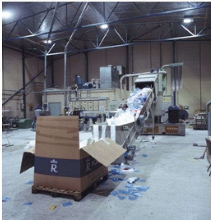
Teollisuuden muovi-jätteen granulointi. Kuva: Tero Pajukallio.
