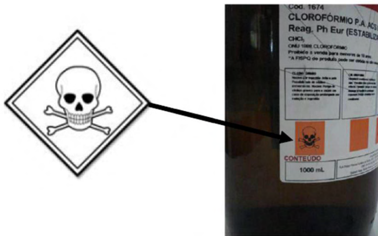
Figura 2. Símbolo de perigo para substâncias tóxicas, presente na embalagem do produto químico (ASSOCIAÇÃO BRASILEIRA DE NORMAS TÉCNICAS, 2010a).
