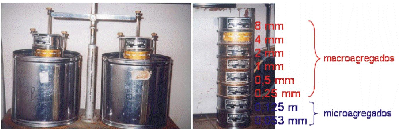
Figura 2. Aparelho de oscilação vertical e a série de peneiras.
