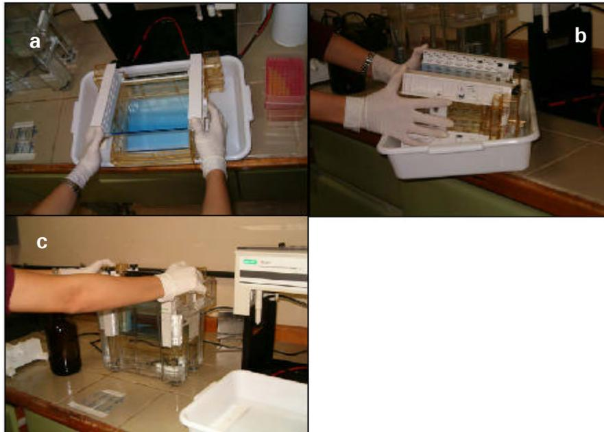
**Fig. 7.** Montagem do sistema *Dcode*. a) e b) Encaixe do gel no suporte; c) ajuste do sistema dentro da cuba.
