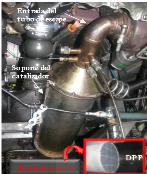
Figura 2.18. Fotografía de una sección del escape del motor diésel montado en el banco de pruebas. Se observa el soporte metálico dentro del cual se coloca el filtro DPF (imagen con recuadro rojo) o el monolito de cordierita de panal de abeja.
