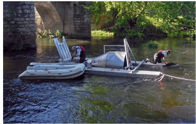
Figura 8: Revisión de la trampa para capturar juveniles de peces migradores en descenso utilizada en el proyecto MIGRANET (Río Umia, Galicia).
