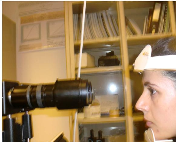
Fig.3. Disposición de las dos cámaras. Éstas se sitúan a la misma distancia del sujeto enfocando cada una de ellas a uno de los ojos del sujeto.
