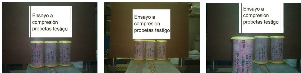
Fotografías nº 24, 25 y 26 Probetas Testigo Refrentadas.
