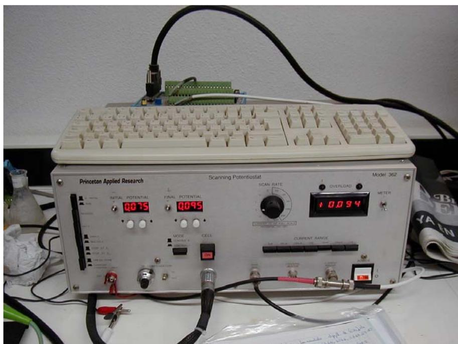
Fotografía IV.2. Potenciostato utilizado
