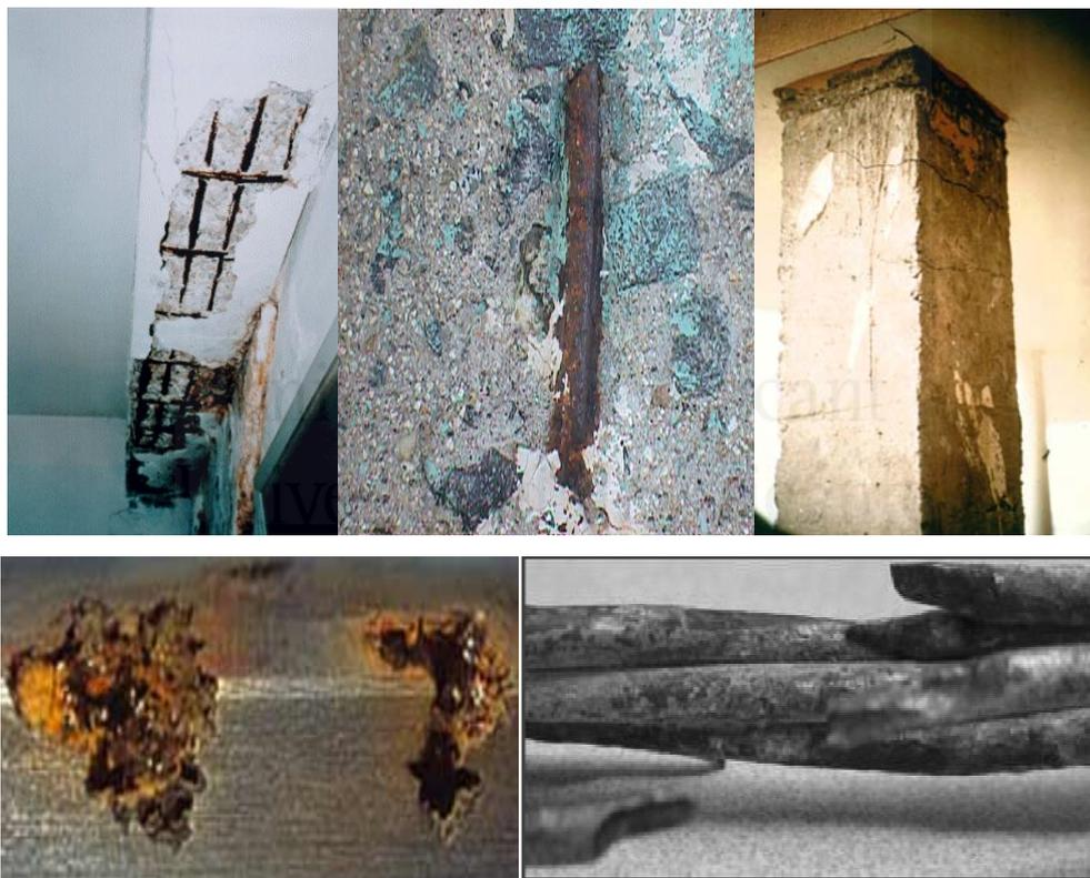
**Foto I.1.** Ejemplos de las consecuencias de la corrosión del acero en el hormigón : a) laminación del recubrimiento de hormigón; b) pérdida de adherencia entre hormigón y armadura; c) fisuración de pilar ; d) reducción de la sección de la barra debido a corrosión por picadura; e) rotura frágil de acero pretensado debido a fragilización por hidrógeno
