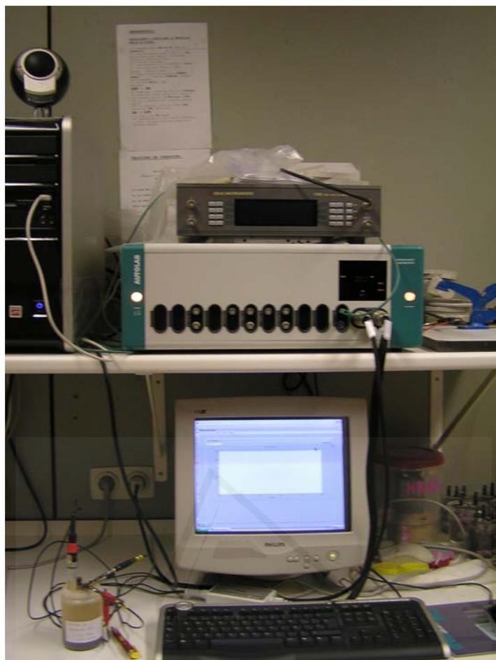
**Fotografía IV.6.** Analizador de frecuencias y conexiones con la disolución
