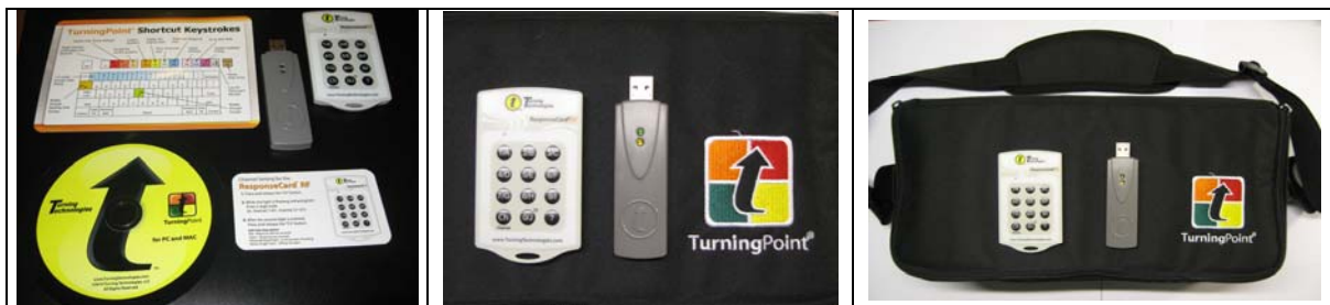
Figura 2. Dispositivos emisores y receptor del sistema de votación por RF.
