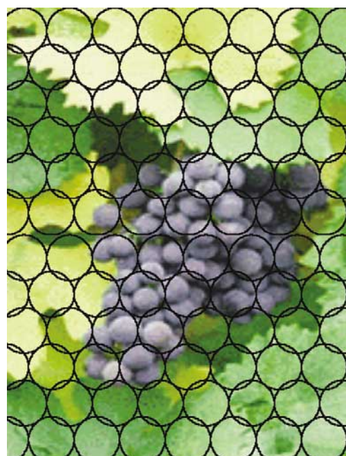
Fig. 1. Ejemplo de muestreo espacial con una red de fotorreceptores separados \Delta d (frecuencia de muestreo 1/\Delta d ).
