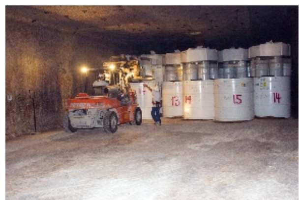
Almacenado de residuos radiactivos en la Waste Isolation Pilot Plant, en Carlsbad (Estados Unidos).
