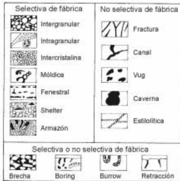
Fig. 2-4. Clasificación de la porosidad según Choquette y Pray (1970).
