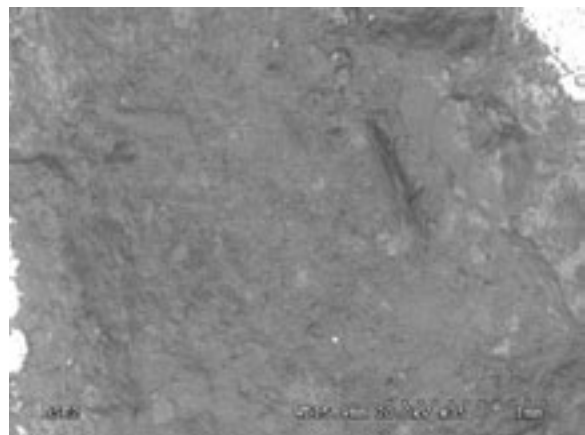
Figura 4: Fondo de la zona rehundida que rodea al círculo central vidriado de la cara superior del molde (x35, zona del análisis III).
