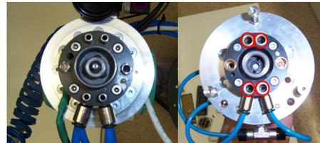
Figura 11: Intercambiador de herramientas. A la izquierda el macho, y a la derecha el hembra
