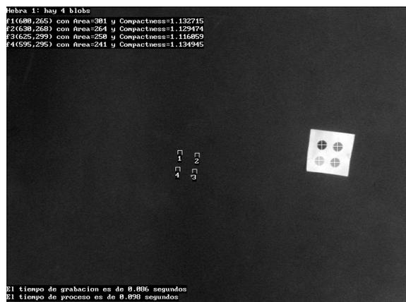
Figura 5: Detección de cuatro puntos
