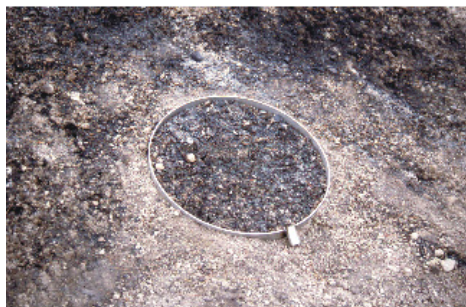
Figura 1.3. Pabela para los experimentos con lluvia simulada, una vez instalada en el campo.
