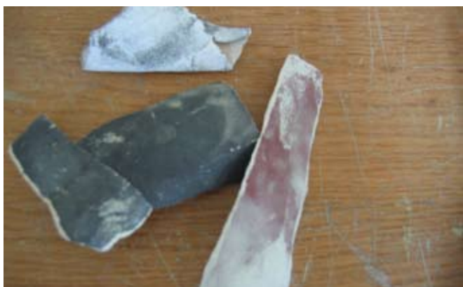
Sandpapper med olika grovhet är bra för att nå en fin yta.
