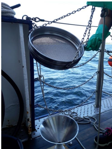
Abbildung 4: Beprobung der SML mittels Garret Screen Technik (Foto: Dennis Booge).
