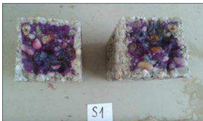
12. ábra: Az F&T beton fenolftaleines vizsgálata
