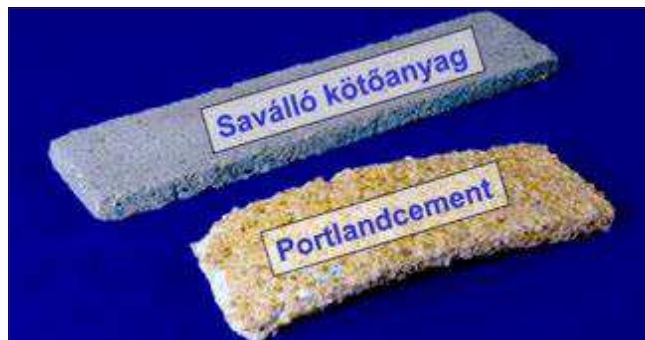
8. ábra: Kénsavban áztatott próbatetek roncsolódása 75 napos tárolás után: alul egy tiszta szulfátálló portlandcementből készült, felül pedig cementet, pernyét és mikroszilikát is tartalmazó 10x40x160mm-es habarcslemez látható. (Hüttl - Hillemeier, 2000)
