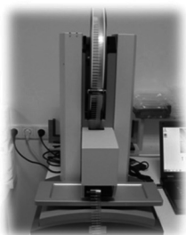
RockImager (Formulatrix) Kristálymonitorozó termosztált robot, UV /VIS mikroszkópokkal
