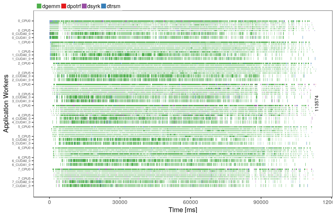
Figura 2. Anomalias (marcadas por cor mais forte) em um core (principalmente CPU0) em cada nó da plataforma chifflet durante a execução da fatoração de Cholesky em uma matriz com 108 \times 108 blocos de 1440 \times 1440 utilizando o escalonador LWS e P=4 .
