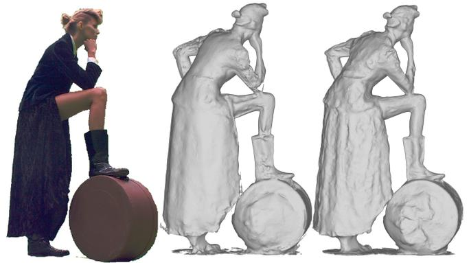
FIGURE 1 – Scène dynamique complexe, capturée avec un système multi-caméras passif. (*gauche*) une image d’entrée, (*centre*) reconstruction obtenue avec des descripteurs d’image classiques [21], (*droite*) solution proposée. Notre résultat confirme les améliorations que peuvent apporter une approche d’apprentissage, globalement plus robuste dans les zones bruitées ou de faible contraste, telles que les plis de la robe, le bras ou la jambe du modèle.
