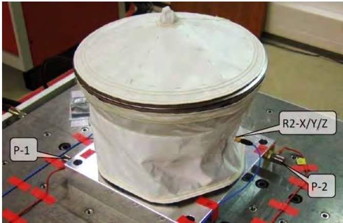
Fig. 19: Net: Vibration EVT Testing.
