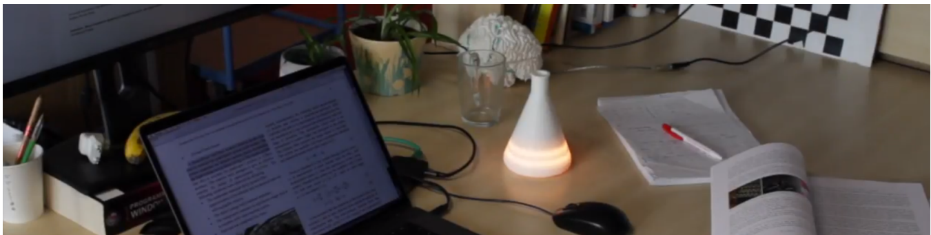
FIGURE 1: L'interface tangible Erlen est une interface permettant de rendre physique la consommation énergétique du poste de travail d'un utilisateur à travers un objet tangible en forme d'erlenmeyer. Cet objet contient un ruban de LED affichant une simulation de fluide représentant de l'eau.
