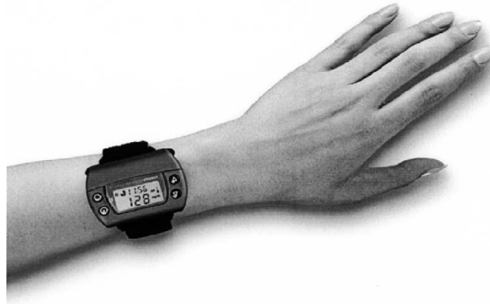
Figure 11 : Le biocapteur à glucose : GlucoWatch ® G2 Biographer (Cygnus) 60
