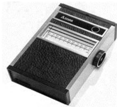
Figure 13 : Le premier lecteur de glycémie, le réflectomètre Ames 65
