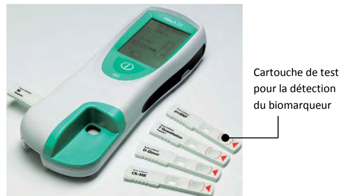
Figure 22 : Un dispositif portable : le cobas h 232® de Roche Diagnostic 106
