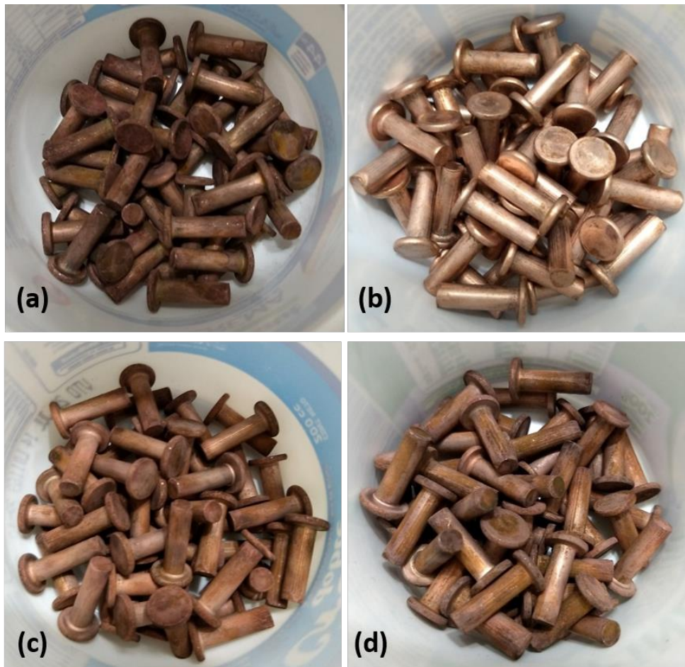
Figura 5.26. Remaches cobreados en tambor rotatorio (a) sin aditivo (b) TEPA (c) PQ-7 (d) PQ-2
