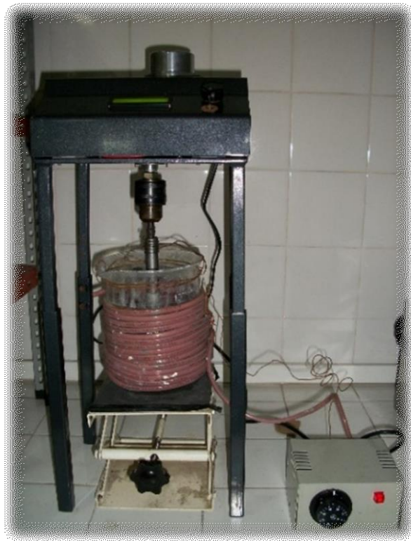
Figura 3.2. Celda de cilindro rotante para obtención de depósitos de cinc
