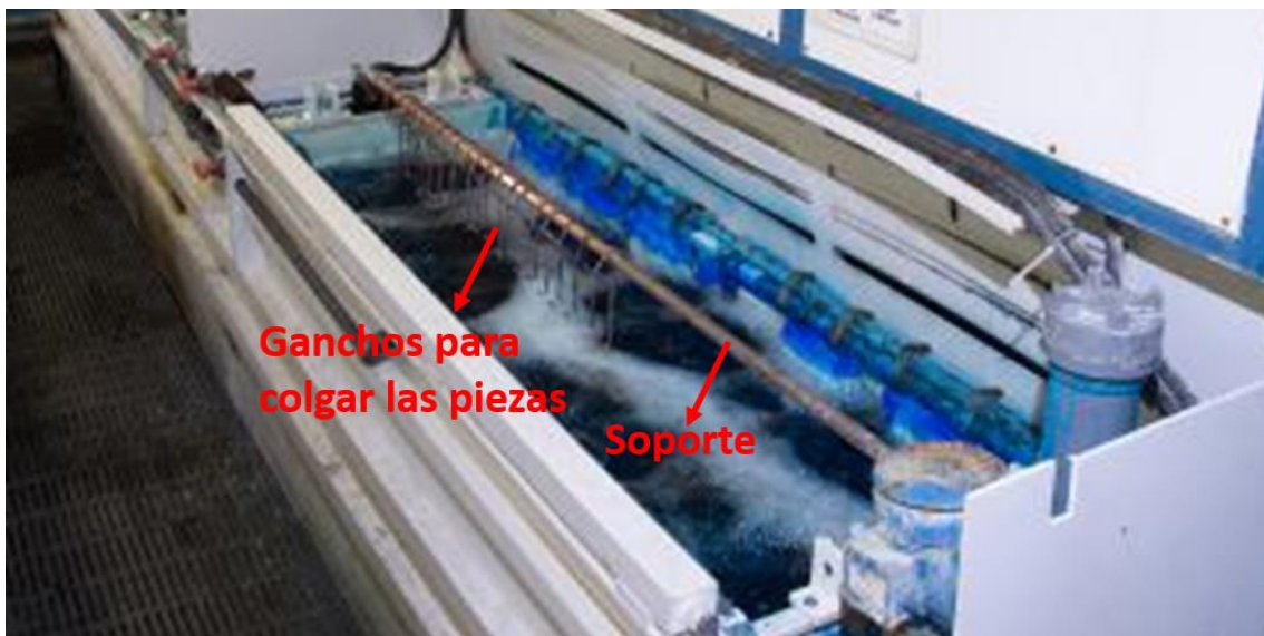
Figura 5.1. Celda tipo rack industrial con electrolito de cobreado
