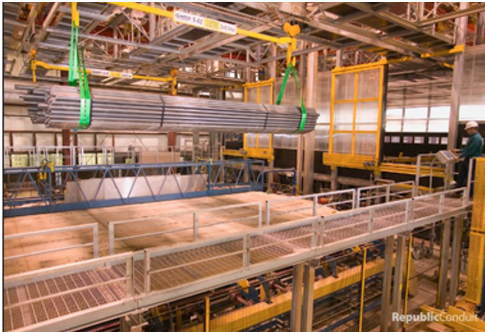
Figura 1.3. Línea de cincado alcalino sin cianuro (E.E.U.U).
