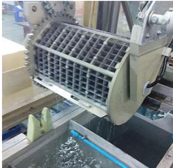
Figura 5.2. Ejemplo de una celda industrial típica de tambor rotatorio
