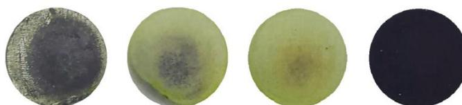
**Abbildung 77:** Anode, Separatoren und Kathode einer gezykelten Zelle (Elektrolyt:  $1 \text{ M}$  Verbindung **38** in DOL) nach  $600$  Zyklen.
