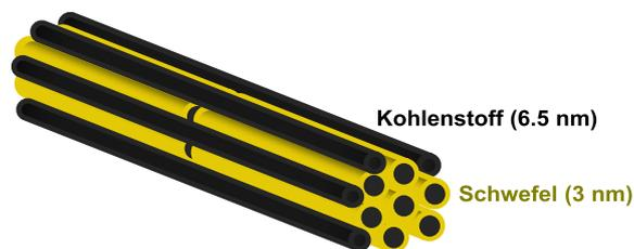
**Abbildung 16:** Mesoporöser Kohlenstoff (CMK-3) mit eingelagertem Schwefel (gelb).<sup>[21]</sup>
