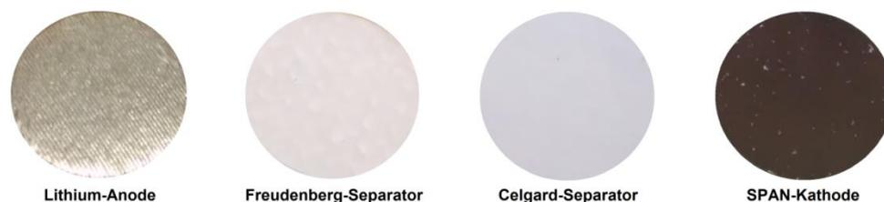
**Abbildung 106:** Abbildung der verwendeten Zell-Bestandteile; Lithium-Anode, Freudenberg-Separator, Celgard-Separator, SPAN-Kathode.
