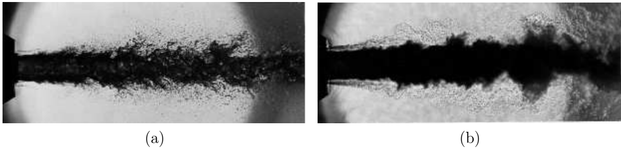
Abbildung 1.2: Schattengraphbilder eines turbulenten, kryogenen N_2 -Strahls in einer He-Umgebung bei Raumtemperatur mit unterkritischer (10 bar) (a) und transkritischer (60 bar) (b) Einspritzung (Mayer et al. (1998) [134]).
