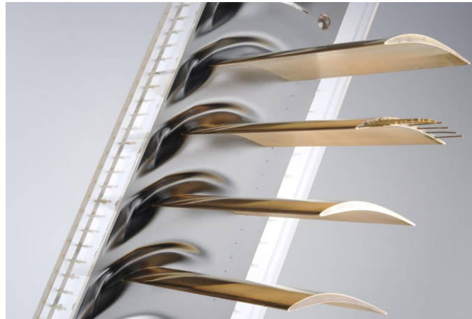
(b) Lineare Verdichterkaskade [48]
