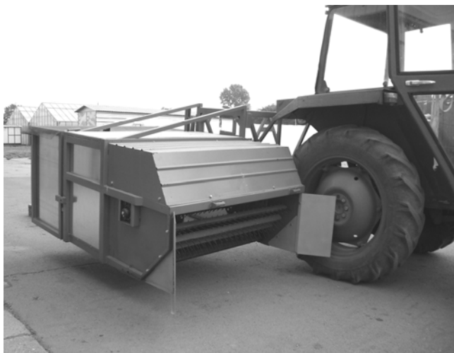
Slika 1. Traktorom nošena mašina za branje cvasti kamilice sa radnim organom tipa virtualnog rotirajućeg češlja sa zubima širokog razmaka
