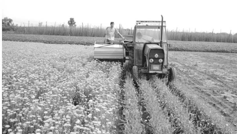
Slika 3. Mašina sa virtualnim rotirajućim češljem pri branju cvasti nevena Figure 3. Tractor with virtual rotating comb type harvester in marigold inflorescences harvest
