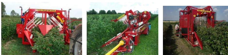
Slika 1. Prikaz vučeni berač "Natalia-V", vučeni berač "Natalka" i samohodni berač "Natalia-p" firme Weremczuk-a
