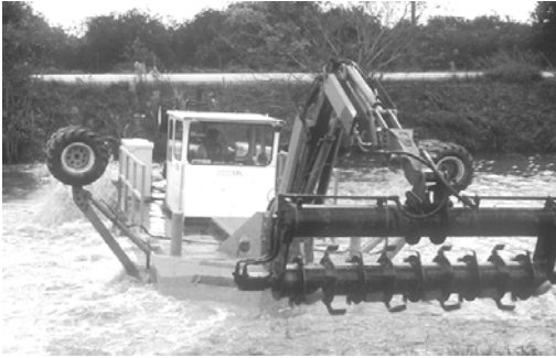
Сл. 4. Машина за култивирање дна аквасистема
