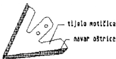
Slika 7. Šematski prikaz navarivanja motičice špartača
