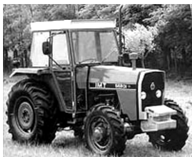
Sl. 3, 4. Kabina i zaštitni ram na traktorima za povećanje bezbednosti u radu [20]
