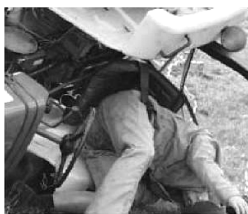
Sl. 5, 6. Sigurnosni kaiševi za vezivanje rukovaoca za osnovi sedišta traktora [25]
