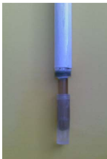
Sl. 3. Redox sonda u zaštitnoj cevi
