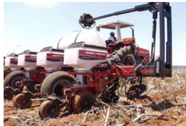
Sl. 15 Sejalica za direktnu setvu Massey Ferguson 555
