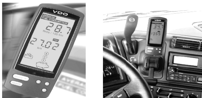
Sl. 2. Elektronska jedinica za kontrolu potrošnje goriva
