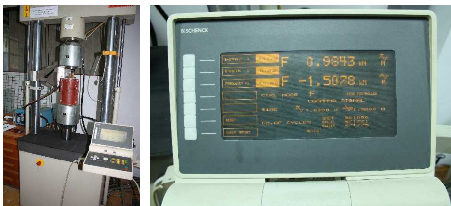
Slika 5.75. Dinamičko ispitivanje tumorske modularne endoproteze na pulzatoru, Fakultet tehničkih nauka, Novi Sad
