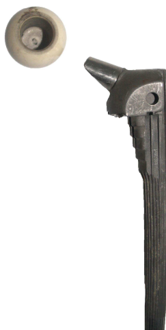
Slika 2.17. Popuštanja mehaničke veze između vrata i glave endoproteze
