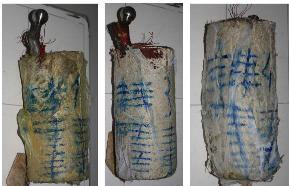
a) Uzorak 1, 28.02.2017. b) Uzorak 3, 28.02.2017 c) Uzorak 4, 28.02.2017 Slika 5.141 Kontrola na Rtg aparatu nakon trideseti i druge faze, 16.000.000 ciklusa
