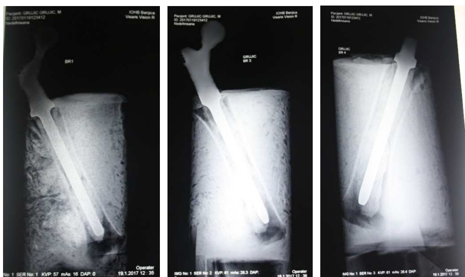
a) Uzorak 1 19.01.2017. b) Uzorak 3, 19.01.2017. c) Uzorak 4, 19.01.2017. Slika 5.138 Kontrola na Rtg aparatu nakon tridesete faze, 15.000.000 ciklusa
