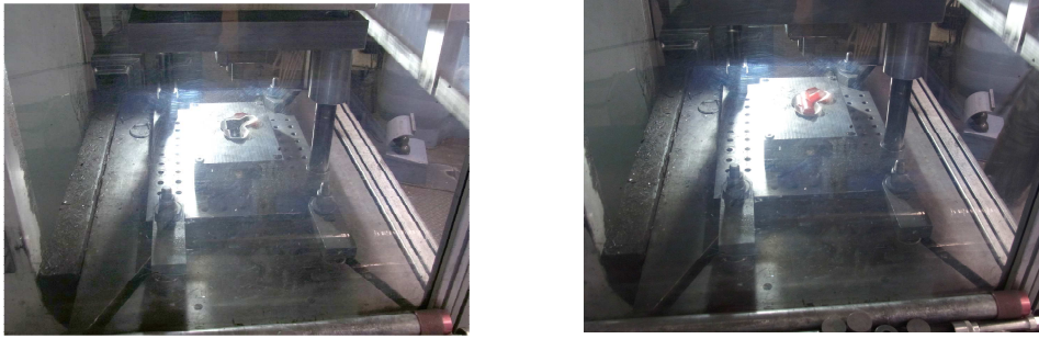
Slika 6.12. Izgled radnog prostora prese za toplo oblikovanje a) sa gnezdom alata b) sa pripremkom u toplom stanju
