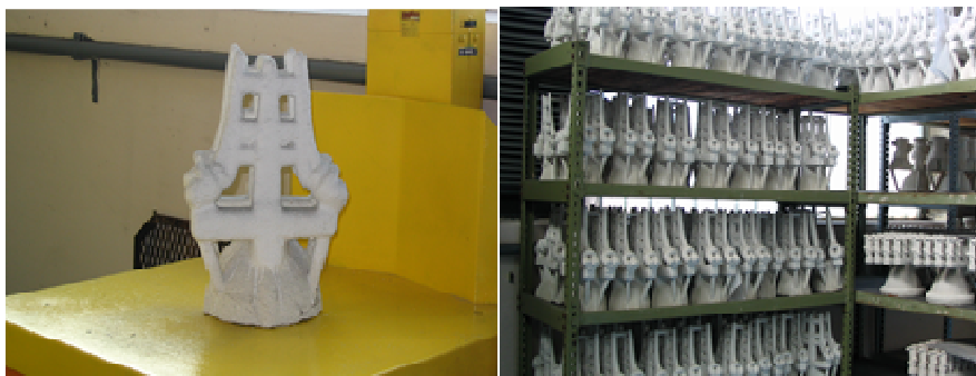
Slika 6.9. Keramička školjka izrađena na osnovu voštanih modela
