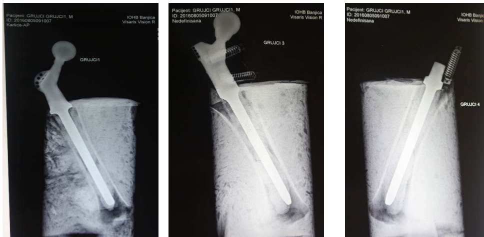
a) Uzorak 1 05.08.2016. b) Uzorak 3, 05.08.2016. c) Uzorak 4, 05.08.2016. Slika 5.108 Kontrola na Rtg aparatu nakon dvanaeste faze, 6.000.000 ciklusa
