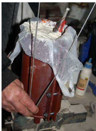
Slika 5.14. Ulivanje dvokomponentne mase, a) dvodelni rastavljivi pribor, b) orejntacija endoproteze
