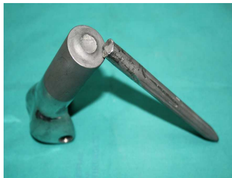
Slika 3.30. Lom tumorske endoproteze na kritičnom preseku zgloba kolena na kritičnom prelazu
