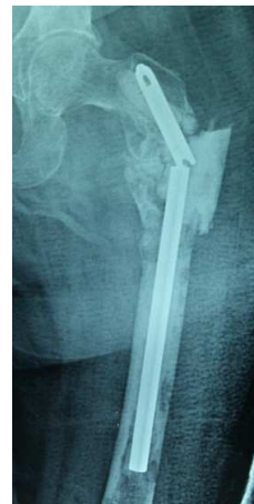
Slika 3.34. a) Koštani tumori sa patološkim prelomom na gornjem delu butne kosti b) Lom intramedularnog klina nakon sanacije koštanog tumora
