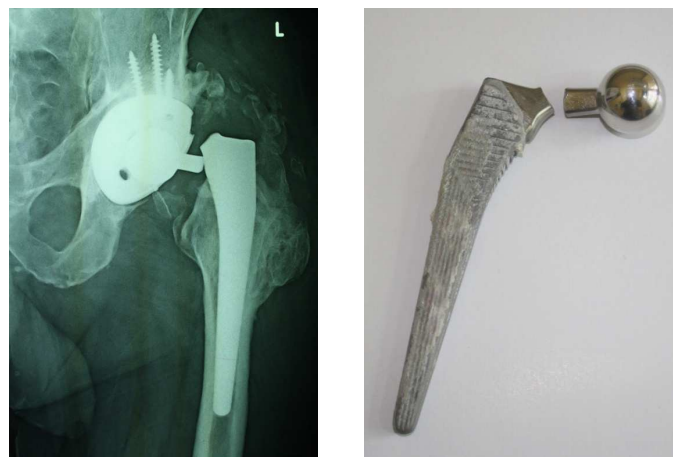
Slika 3.42. Prelom vrata endoproteze zgloba kuka usled zamora materijala
