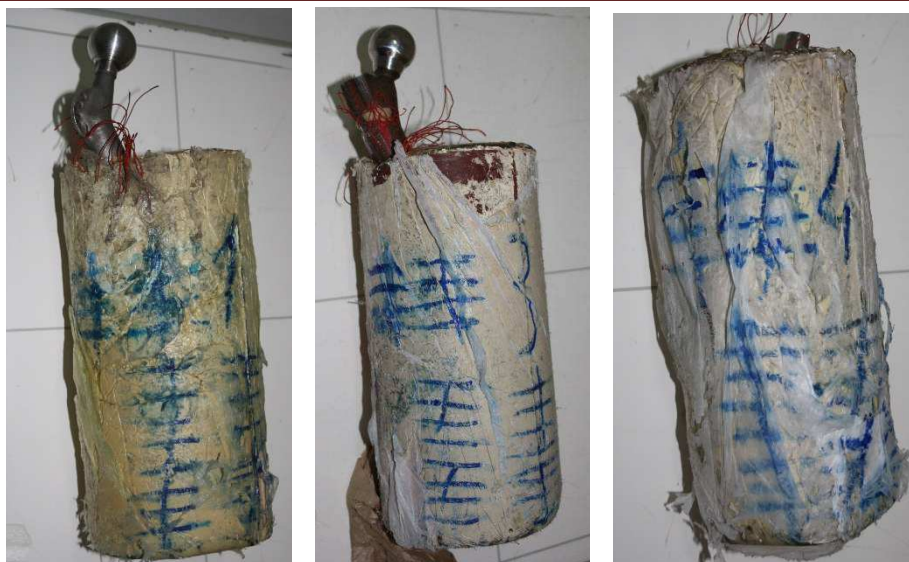
a) Uzorak 1, 19.01.2017. b) Uzorak 3, 19.01.2017. c) Uzorak 4, 19.01.2017. Slika 5.137 Kontrola na Rtg aparatu nakon tridesete faze, 15.000.000 ciklusa
