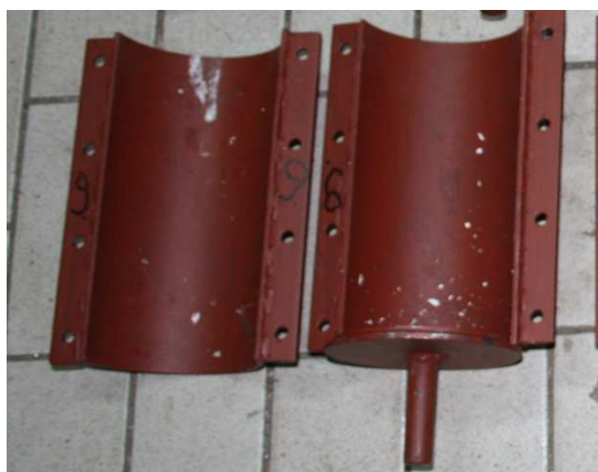
Slika 5.14. Ulivanje dvokomponentne mase, a) dvodelni rastavljivi pribor, b) orejntacija endoproteze
