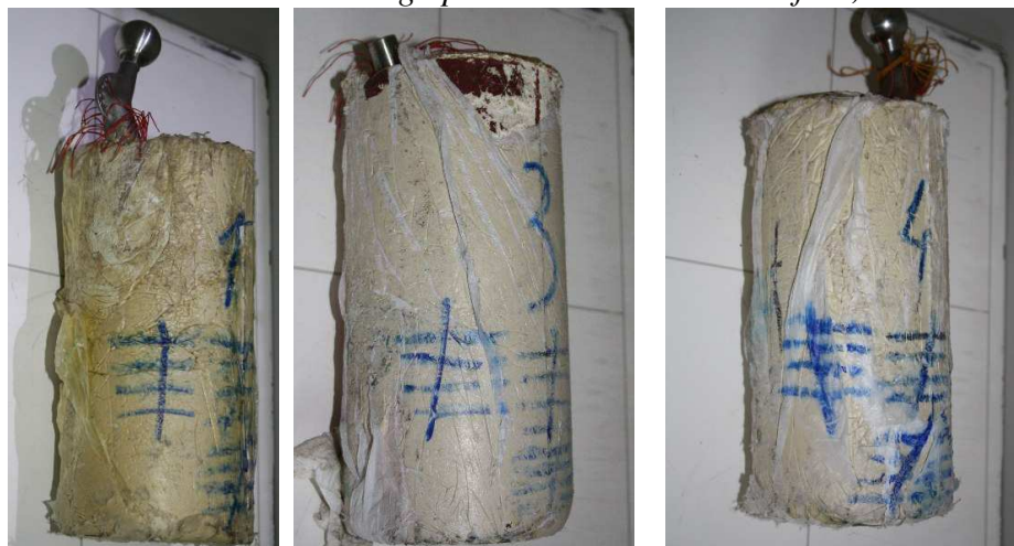
a) Uzorak 1 24.08.2016. b) Uzorak 3, 24.08.2016. c) Uzorak 4, 24.08.2016. Slika 5.113 Kontrola na Rtg aparatu nakon petnaesta faze, 7.500.000 ciklusa
