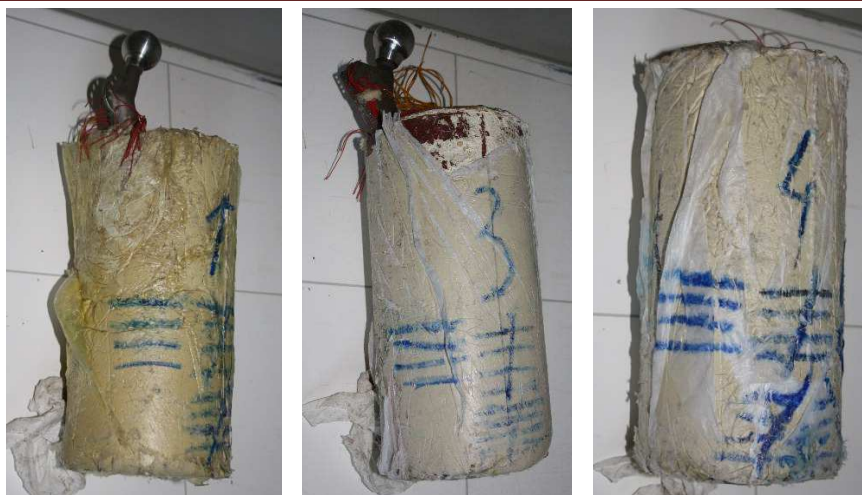
a) Uzorak 1 19.08.2016. b) Uzorak 3, 19.08.2016. c) Uzorak 4, 19.08.2016. Slika 5.111 Kontrola na Rtg aparatu nakon četrnaeste faze, 7.000.000 ciklusa
