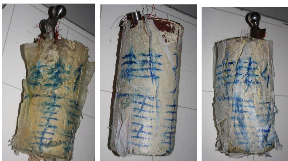
a) Uzorak 1, 07.02.2017. b) Uzorak 3, 07.02.2017 c) Uzorak 4, 07.02.2017 Slika 5.139 Kontrola na Rtg aparatu nakon trideseti prve faze, 15.500.000 ciklusa
