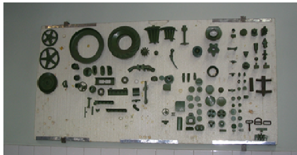
Slika 6.8. Voštani modeli delova predviđenih za izradu preciznim livenjem u vakuumu
