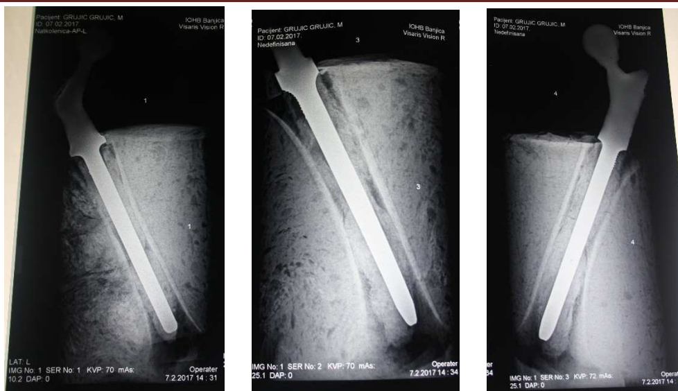
a) Uzorak 1, 07.02.2017. b) Uzorak 3, 07.02.2017 c) Uzorak 4, 07.02.2017 Slika 5.140 Kontrola na Rtg aparatu nakon trideseti prve faze, 15.500.000 ciklusa
