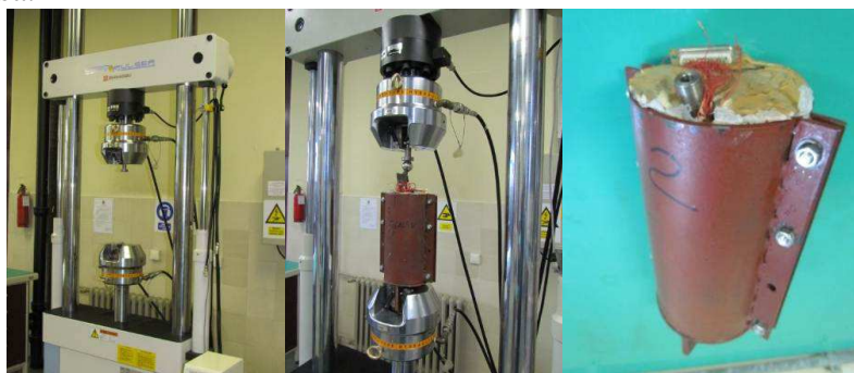
Slika 5.76 Dinamičko ispitivanje tumorske modularne endoproteze na pulzatoru, VTI, Beograd
