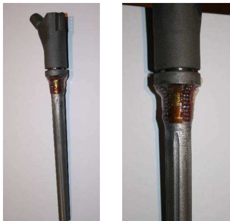
Slika 5.11. Postavljanje lanca mernih traka (HBM 120KY11)
