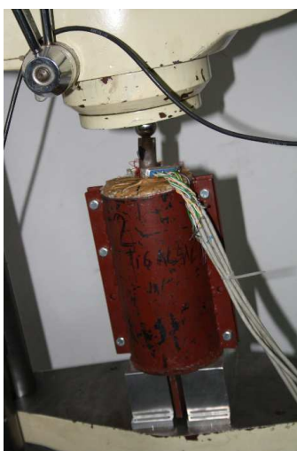
Slika 5.170. Ispitivanje, tumorske modularne endoproteze, kontrolno merenje pod dejstvom statičkog opterećenja 10.08.2017. godine uzorak 2-s kratki vrat
