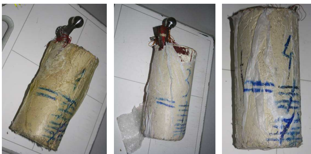
a) Uzorak 1 05.08.2016. b) Uzorak 3, 05.08.2016. c) Uzorak 4, 05.08.2016. Slika 5.107 Kontrola na Rtg aparatu nakon dvanaeste faze, 6.000.000 ciklusa
