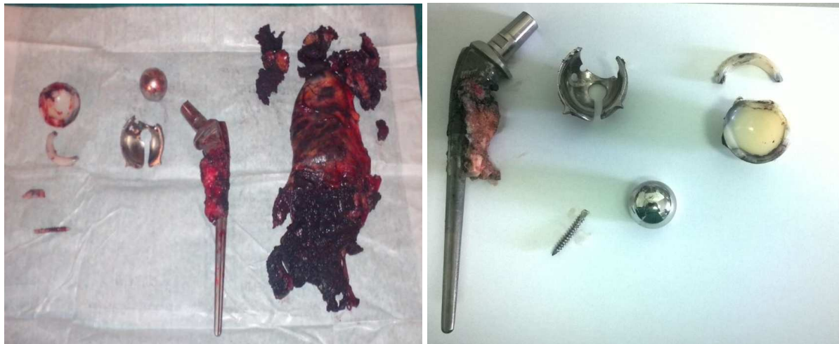
Slika 6.20. Koplukacija nakon ugradnje implantata a) metaloza, b) mehaničko oštećenje implantata
