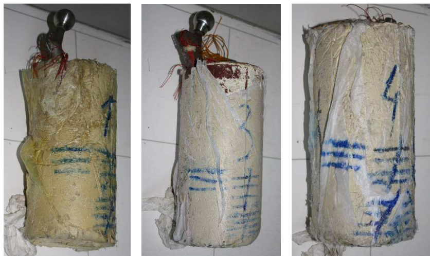
a) Uzorak 1 12.08.2016. b) Uzorak 3, 12.08.2016. c) Uzorak 4, 12.08.2016. Slika 5.109 Kontrola na Rtg aparatu nakon trinaeste faze, 6.500.000 ciklusa
