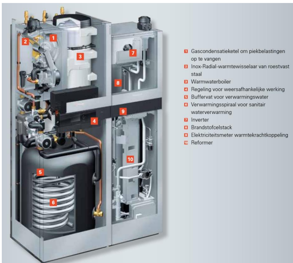
Figuur 5 - Schematisch overzicht van de systeemcomponenten in de Viessmann Vitovalor 300-P
