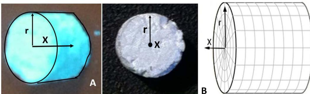
**Figura 25:** A: Fotografía en dos proyecciones de la pieza del biomaterial (visión lateral oblicua y craneocaudal). B: esquema matemático de estudio de los valores de los píxeles obtenidos con el microTC. "r" representa el valor de cada voxel respecto al eje central "X" anteroposterior o longitudinal de la pieza.
