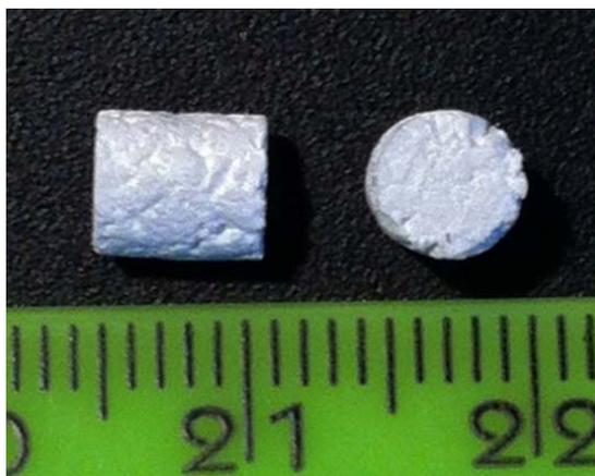
**Figura 11:** Aspecto macroscópico de los cilindros del compuesto. Nurse's A phase-silicocarnotita
