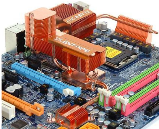
Fig. 8. Tubos de calor aplicados en la refrigeración de una placa madre.
