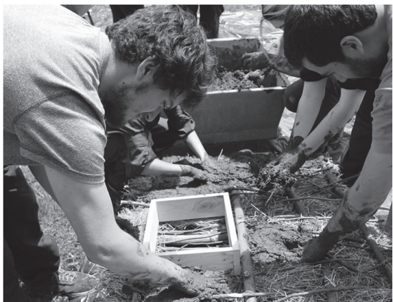
Figura 1: Trabajo teórico- práctico con tierras y adobes realizado en el laboratorio de materiales U. del Bío-Bío.
