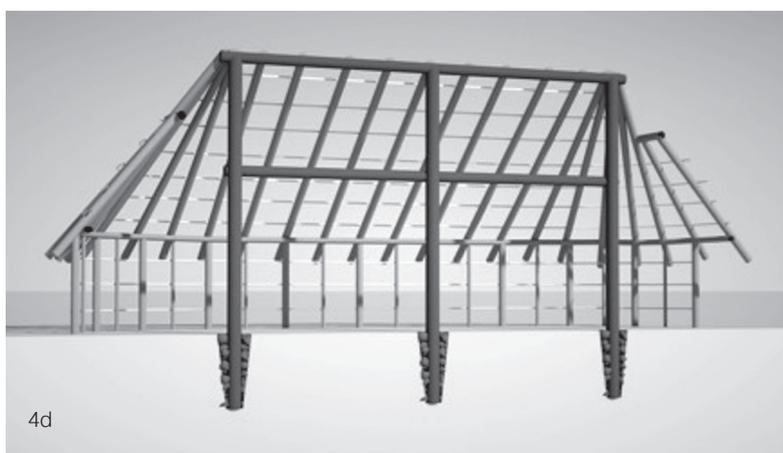
Figuras 4c y 4d: Empotramiento de los postes estructurantes, con piedras y tierra apisonada. Modelación: Gaspar Morgado.
