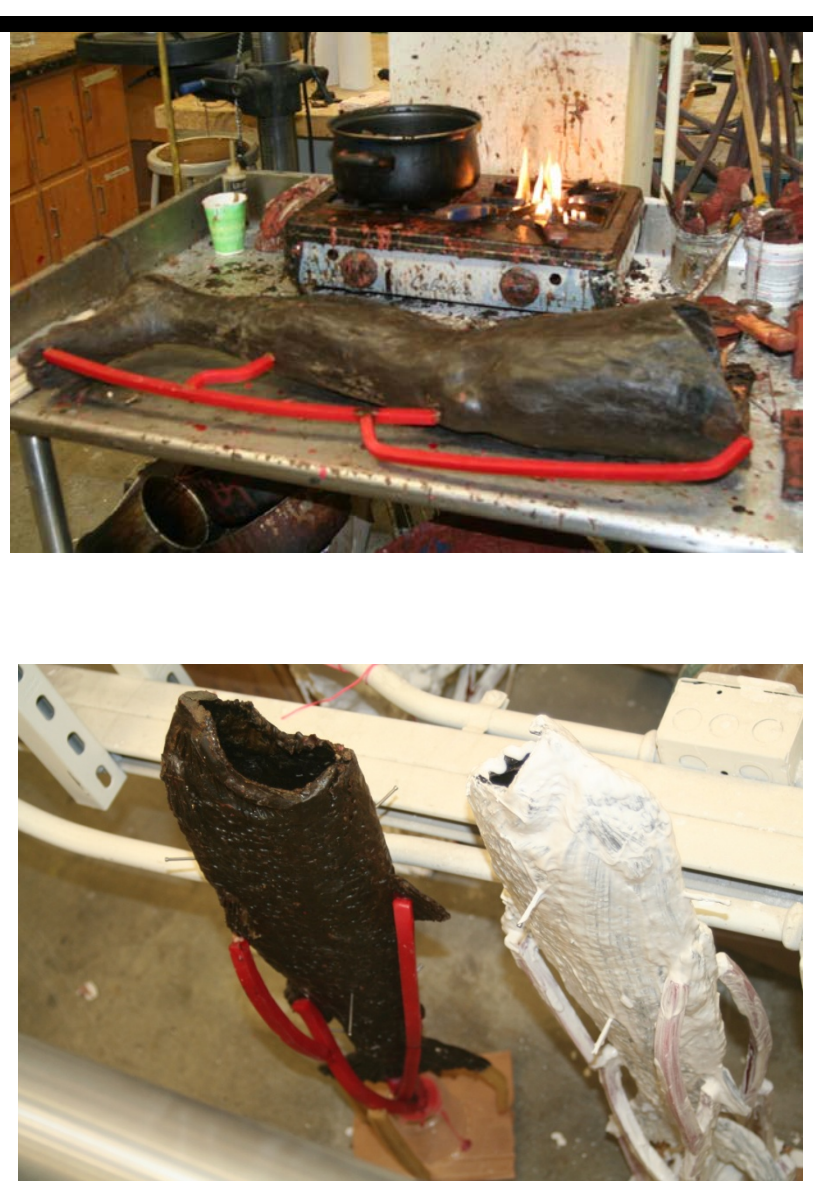
Attaching the sprues, vents, core pins, and pour cup
